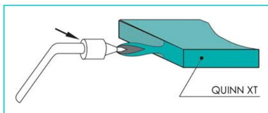
Eine weitere Möglichkeit ist das **Polierfräsen** mit Diamantwerkzeugen. Die Qualität der Oberfläche ist so gut, dass sie nicht weiter bearbeitet werden muss. Das Polierfräsen führt in einem Arbeitsschritt, ohne Vorschleifvorgang, zu einem exzellenten Polierergebnis. Bei dieser Technik treten kaum innere Spannungen auf und das, bei den anderen Verfahren notwendige Tempern, kann gegebenenfalls entfallen.
