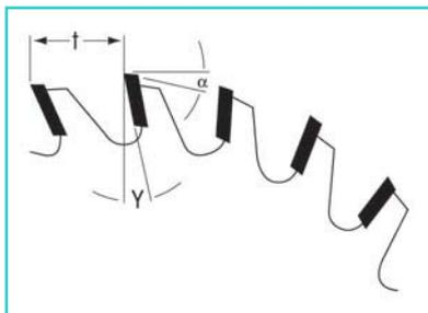
Bandsägen werden häufig zum Besäumen von Formteilen verwendet. Das Schnittbild ist wegen der leicht geschränkten Sägeblätter etwas rau.
