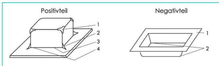
Halbzeug über das Werkzeug gezogen. Dabei können Bereiche des erwärmten Halbzeuges so stark abkühlen, dass keine vollständige Verstreckung möglich ist und Dickstellen entstehen. Die beim Positivformen typischen Probleme wie Faltenbildung (2)
