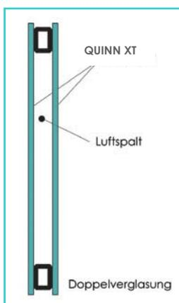
QUINN XT -Platten, die als Verglasung eingesetzt werden, führen zu einer erheblichen Energiekosteneinsparung, da ein übermäßiger Wärmeverlust im Winter und das Eindringen von Wärme im Sommer vermieden werden. Der Wärmeverlustfaktor von QUINN XT, der üblicherweise als K-Wert (U-Wert) bezeichnet wird, ist erheblich niedriger als der von Glas mit der gleichen Dicke.
