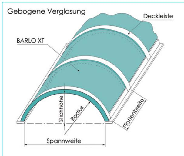
QUINN XT lässt sich hervorragend im kalten Zustand einbiegen. Kalt Einbiegen ermöglicht dünnere Materialstärken als beim planen Eindecken von Dächern, da eine Erhöhung der Eigensteifigkeit der Platte durch die Geometrieänderung erreicht wird. Um eine Materialschädigung durch hohe Randfaser-
