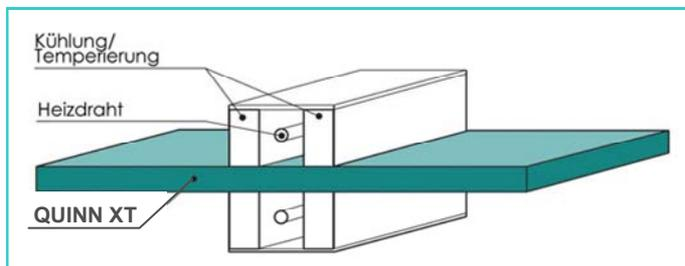
Die linienförmige Erwärmung wird durch Glühdrähte bzw. Heizstäbe durchgeführt. Die Aufheizzeit ist abhängig von der verwendeten Apparatur und nimmt mit der Materialstärke stark zu. Das Abkanten des Materials muss unter geringer Belastung möglich sein, um starke Spannungen im Material zu vermeiden.
